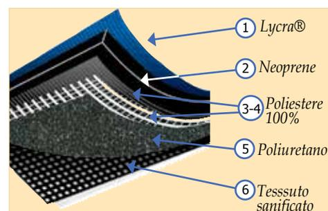
La superficie in Lycra® bielastica NERA (1) è facilmente lavabile e protegge lo strato più interno in Neoprene (2), un espanso a cellula chiusa di 3 mm di spessore ed estremamente elastico.
